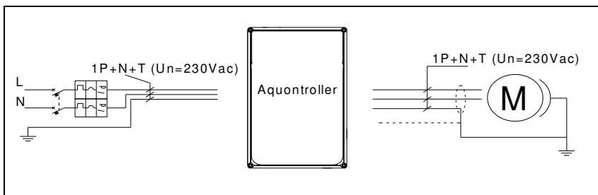
\* section du câble d'alimentation en fonction de la longueur, avec électropompe de 1,5 kW.
